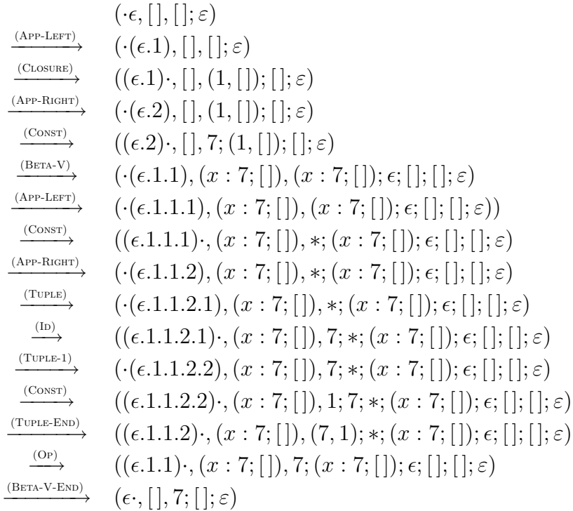
Abbildung 3.7: Small step Berechnungsfolge für (\epsilon, [], []; \epsilon) mit e[\epsilon] = (\lambda x. * (x, 1)) 7
